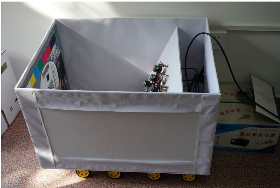
图4 移动式图像传感器辐照损伤测试平台
